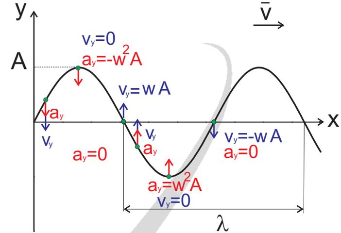
Figura 3. Onda periódica transversal: módulo y dirección de la velocidad y aceleración de la onda en distintos puntos para un dado tiempo.
