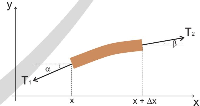
Figura 4. Tensiones que actúan sobre un elemento de soga por la que viaja una onda transversal.
