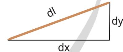
Figura 6. Elemento de soga estirado hasta una longitud  $dl$ .
